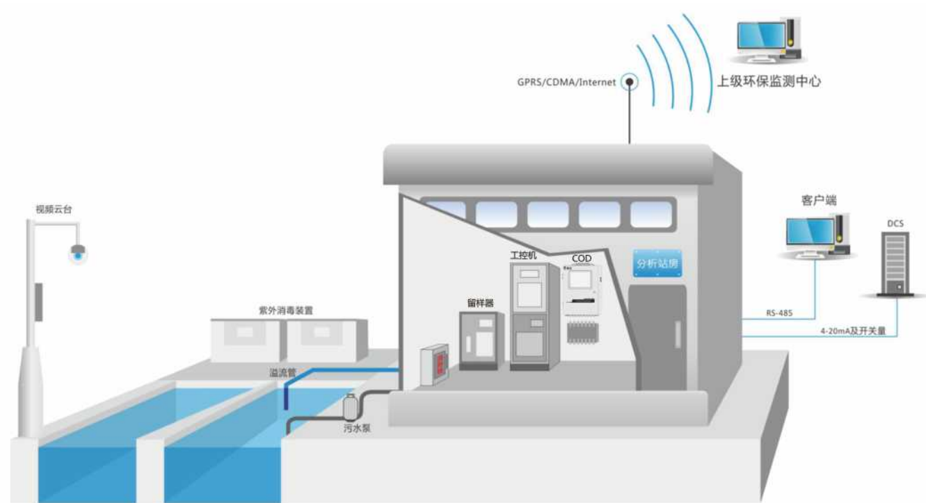
污染源在线监测站房示意图
